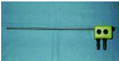
Fig. 8. Cánula de irrigación-aspiración con mecanismo "de trompeta"
